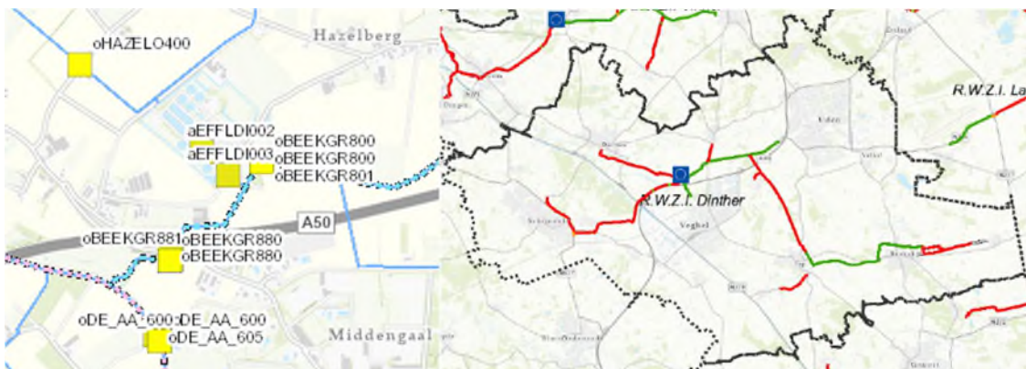
Figuur 20. Op de figuur aan de linkerkant is te zien dat de lozing van effluent uit de RWZI op de Beekgraaf uitkomt en via de Aa doorstroomt naar de Maas. Bij droog weer wordt het effluent omgeleid via de Hazelbergse loop die aan de noord-kant van de RWZI ligt. Op de figuur aan de
